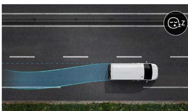
Die **Müdigkeitserkennung** analysiert bei Geschwindigkeiten oberhalb von 60 km/h die Lenkbewegungen des Fahrers. Erkennt das System typische Muster, die auf eine Übermüdung oder auf Unaufmerksamkeit hindeuten, warnt es zunächst optisch und anschließend akustisch.
