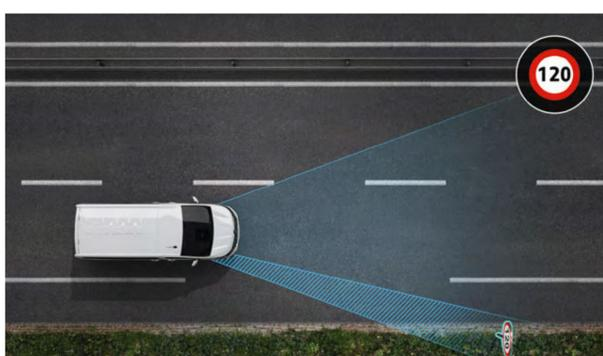
Die **Verkehrszeichenerkennung mit Geschwindigkeitswarner** zeigt Ihnen im Instrumententräger die aktuell zulässige Geschwindigkeit an und warnt Sie, wenn Sie die Höchstgeschwindigkeit überschreiten. Dazu dient eine Kamera oben in der Windschutzscheibe.
