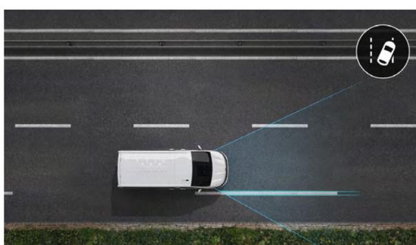
Bei Geschwindigkeiten über 70 km/h macht der **Spurhaltewarner** Sie durch ein optisches und akustisches Signal darauf aufmerksam, wenn Sie, ohne zu blinken, eine durchgezogene oder gestrichelte Fahrbahnmarkierung überfahren.
