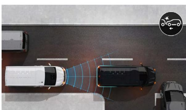
Der **Notbremsassistent** hilft Ihnen, Zusammenstöße zu vermeiden. Sobald der Sensor die Gefahr einer Kollision erkennt und Sie nicht oder nicht ausreichend reagieren, greift das Assistenzsystem ein und bremst das Fahrzeug ab.
