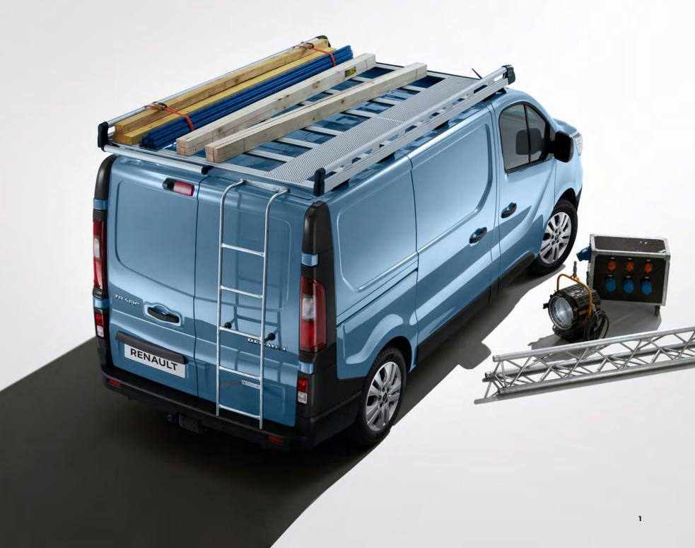
1. Aluminium-Dachgalerie - Dachgepäckträger - Galvanisierte Leiter (82 01 656 829) (82 01 468 187) (82 01 468 217)
