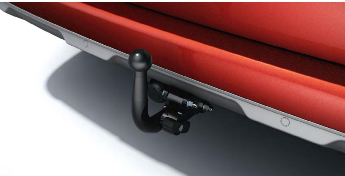
Anhängerkupplung werkzeuglos abnehmbar (51 11 213 72R), (75 61 073 70R), (24 1D 826 79R), (24 1D 886 79R)
