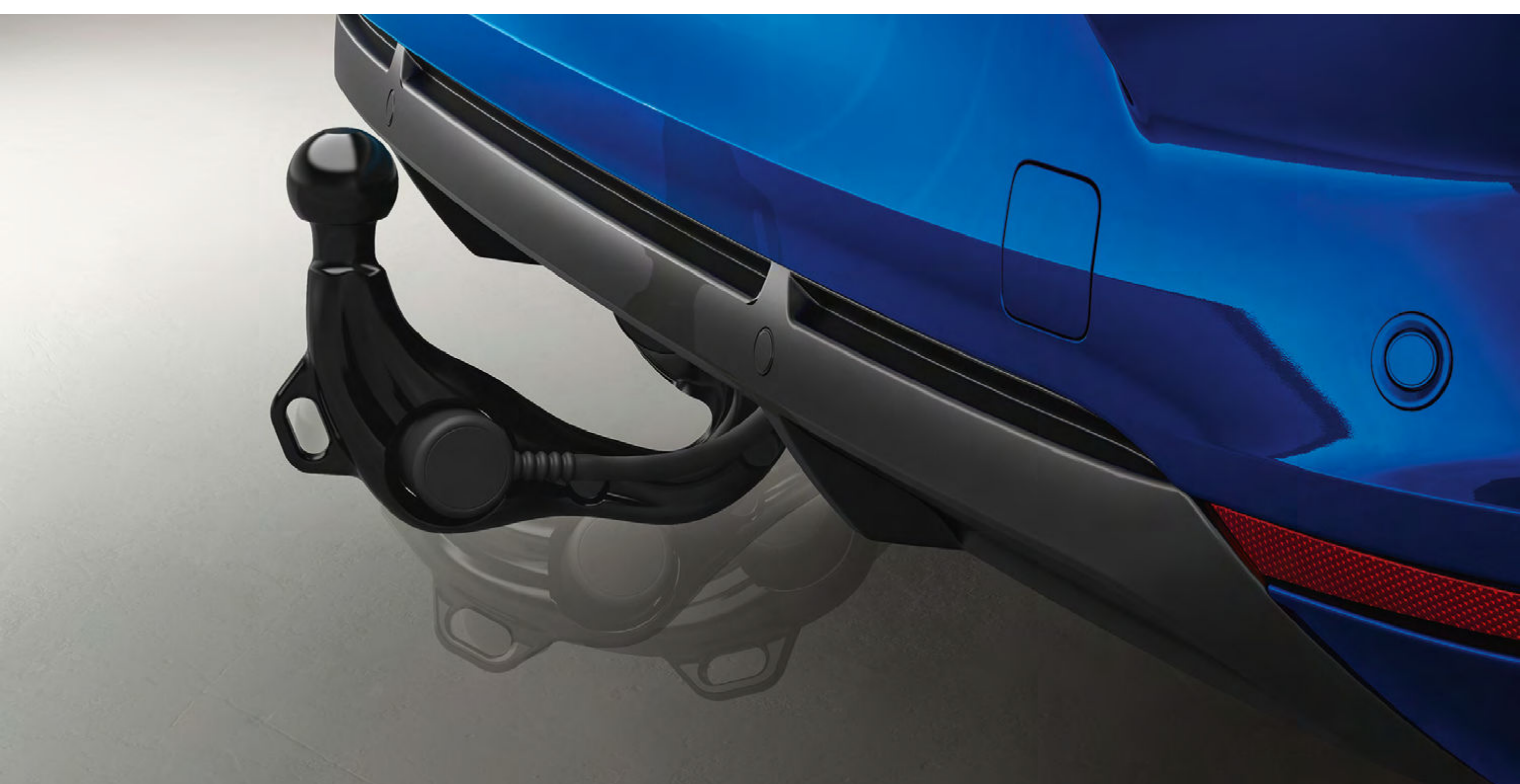
Halbelektrische einklappbare Anhängerkupplung (82 01 707 721/ 82 01 722 213/ 82 01 721 656/ 82 01 724 180/ 82 01 724 181/ 82 01 716 604)
