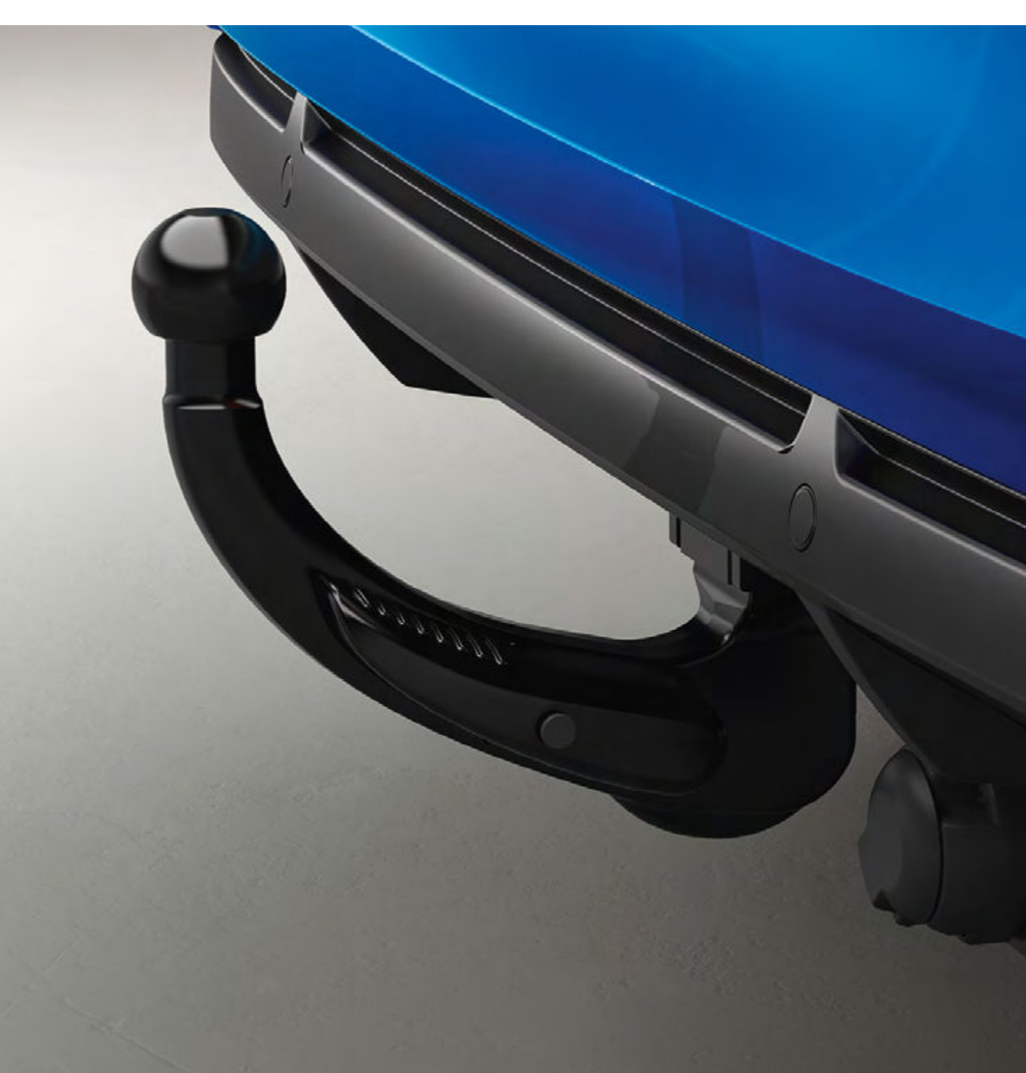
Ohne Werkzeug abnehmbare Anhängerkupplung (75 61 040 25R/ 51 19 951 00R/ 82 01 716 605/ 82 01 724 180)
