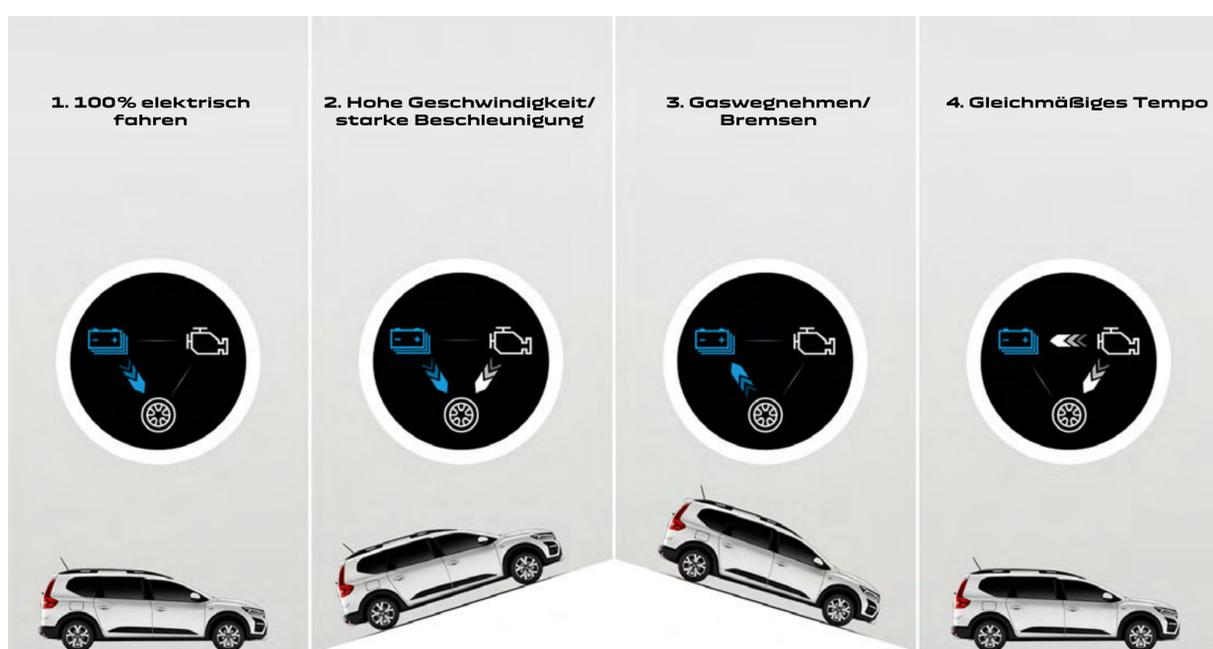
1. Als Antrieb wird ausschließlich der Elektromotor genutzt.
