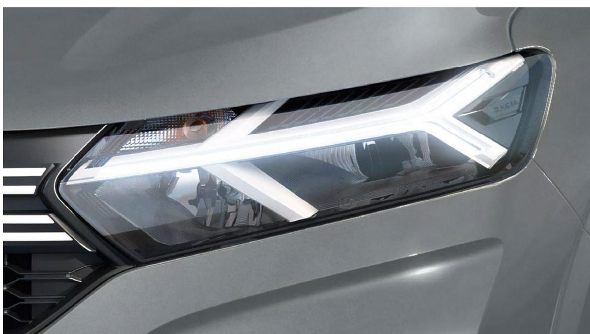
**LED-Tagfahr- und -Abblendlicht mit Lichtautomatik**
