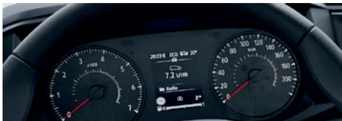
Analoge Instrumententafel mit 3,5-Zoll-TFT-Display bei den Versionen mit Verbrennungsmotor
