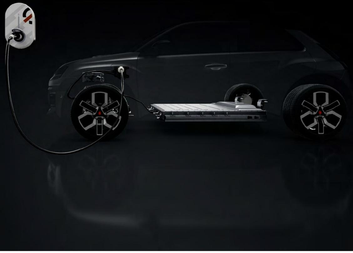
Mit dem Mobilize-V2G-Service<sup>1</sup> wird Ihr Renault 5 dann aufgeladen, wenn die Nachfrage nach Strom besonders gering ist. Während der teuren Verbrauchsspitzen wird gespeicherte Energie aus der Batterie wieder zurück in das Stromnetz geleitet. Das senkt die Stromkosten beim Aufladen zu Hause erheblich.
